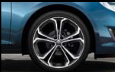
Jante din aliaj, 8 J x 19", design cu 5 spițe bicolore, pneuri 235/40 R 19 (PZT) 8 .
