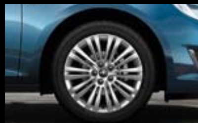
Jante din aliaj, 7 J x 17", design cu 10 spițe duble, pneuri 215 (225)/50 R 17 (PXS) 7 .
