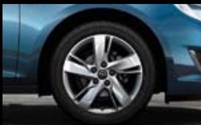
Jante din oțel, 7 J x 17", design cu 5 spițe, pneuri 215 (225)/50 R 17 (RTN) 5 .
