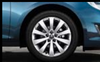
Jante din aliaj, 7 J x 17", design cu spițe multiple, pneuri 215 (225)/50 R 17 (PGQ) 6 .
