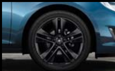
Jante din aliaj, 7,5 J x 18", design cu 5 spițe duble, finisaj Negru Lucios, pneuri 225/45 R 18 (RD9). Sau 8 J x 18", pneuri 235/45 R 18 (PXR) 10 .
