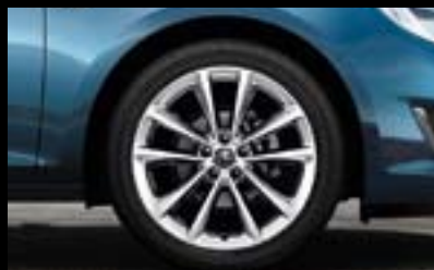
Jante din aliaj, 7,5 J x 18", design cu spițe multiple, pneuri 225/45 R 18 (PZW). Sau 8 J x 18", pneuri 235/45 R 18 (PZK) 9 .
