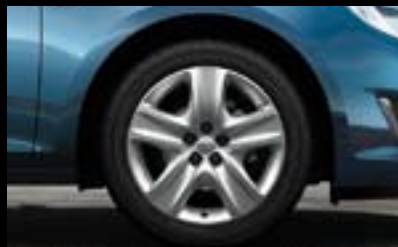
Jante structurale, 7 J x 17", design cu 5 spițe, pneuri 215 (225)/50 R 17 (PWT) 4 .
