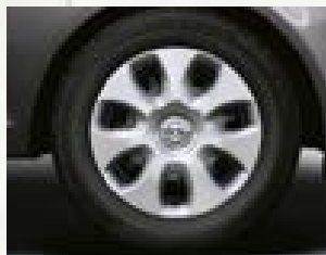
Jantă din oțel incl. capac, 6 J x 15, design cu 7 spițe, pneuri 185/65 R 15 (QV7).
