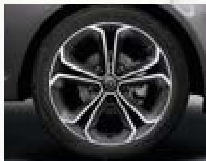
Jante din aliaj, 7 J x 17, design cu 5 spițe, titan mat polișat, pneuri 215/45 R 17 (PNM).
