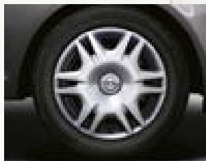
Jantă din oțel incl. capac, 6 J x 16, design cu 6 spițe, pneuri 195/55 R 16 (QV6).
