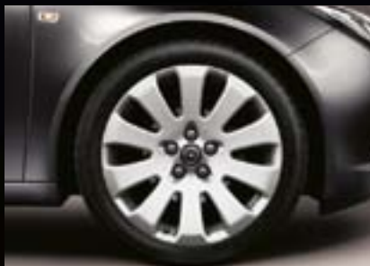
10 Jante din aliaj 8.5 J x 19, design cu 10 spițe, pneuri 245/40 R19 (Q9S). Aliaj cu finisaj prelucrat strălucitor.
