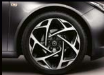
11 Jantă din aliaj, 8.5 J x 19, design cu 6 spițe Y, pneuri 245/40 R19 (Q7P).
